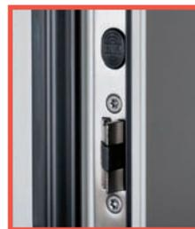
Beim Schließen der Tür fahren die Fallenriegel über einen magnetischen Impuls am oberen und unteren Ende der Tür um 20 mm in die Schließbleiste. Dadurch ist die Tür immer mehrfach verriegelt - ohne ein Nachschließen mit dem Schlüssel. Für maximale Sicherheit!
