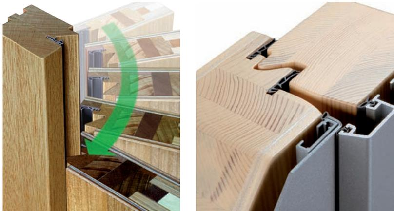
Für Holz-Haustüren haben wir einen Aushebelschutz in Form eines patentierten Keilfalzes entwickelt, der die RC2-Anforderungen erfüllt und bei unseren hochwertigen Haustüren zum Standard gehört.
